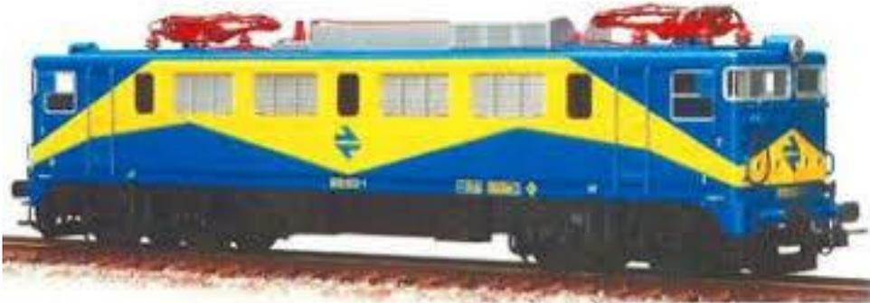
Esta locomotora tiene las luces blancas y rojas cambiando según el sentido de la marcha y la forma de la carrocería no permite más que la inclusión de un decodificador de cables y conector de 8 pines en el domo. Para la inclusión de un decodificador de sonido y el altavoz necesariamente se ha de mecanizar la placa base de la locomotora.
