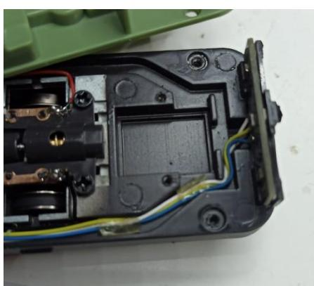
Posteriormente tenemos que quitar la placa de iluminación que va atornillada a sendos soportes con dos tornillos.
