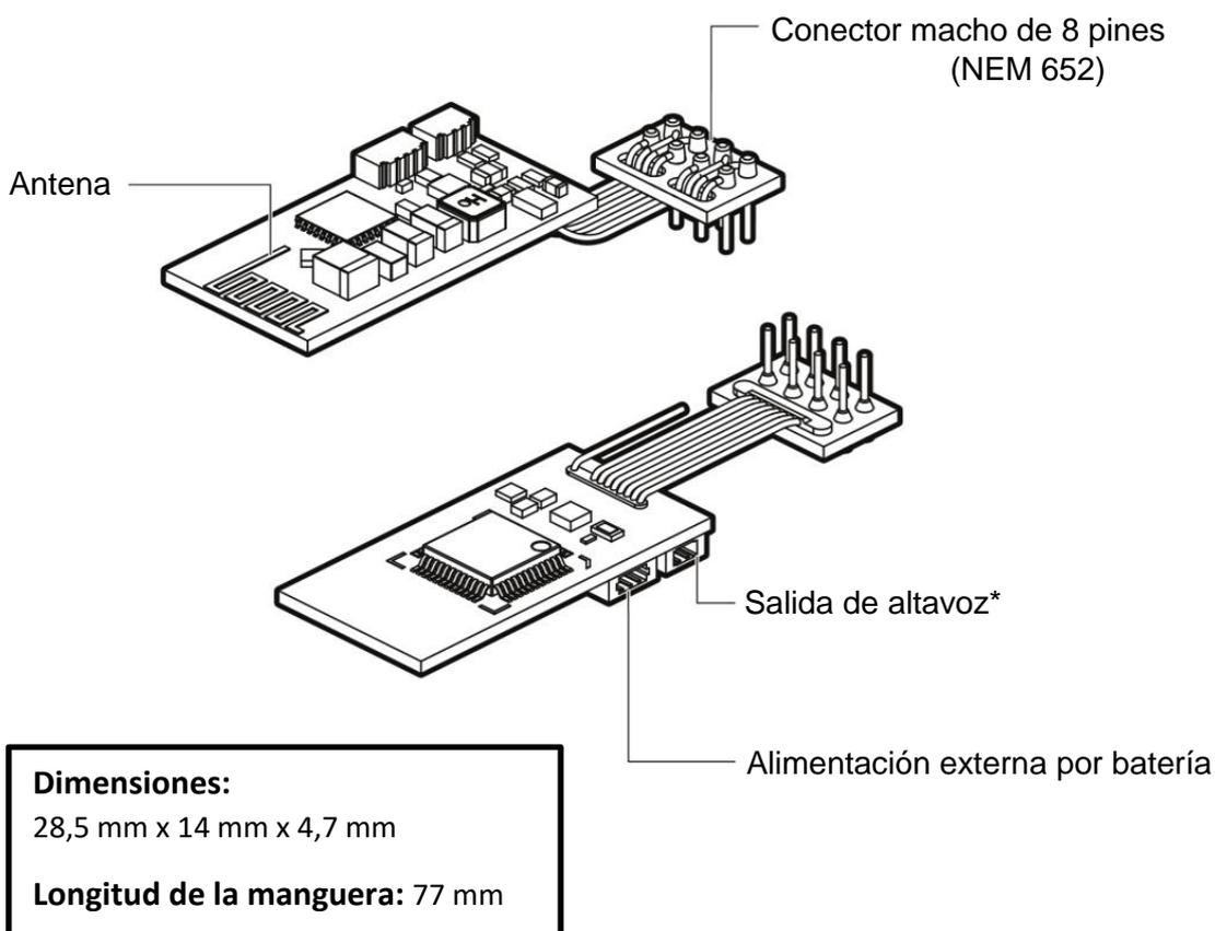
\*Atención: Los altavoces conectados a la placa base de la locomotora funcionarán siempre en paralelo
