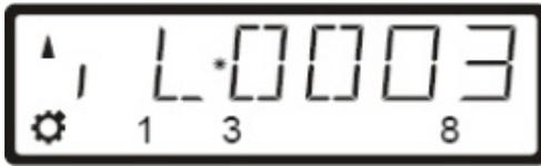
Se está controlando una locomotora (L), con la dirección 0003.
