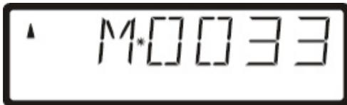
Se está controlando una multitracción con la dirección 0033.
